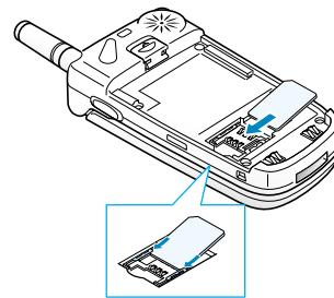
**註：**需要取出 SIM 卡時，如圖所示，輕輕滑出 SIM 卡固定器。
