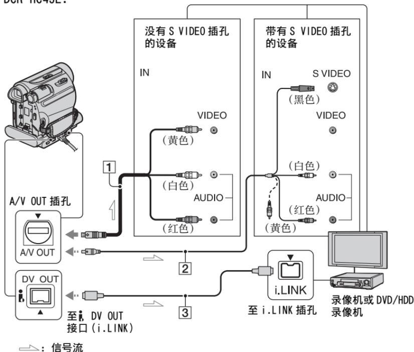
**1 A/V 连接电缆 (随机提供)**
