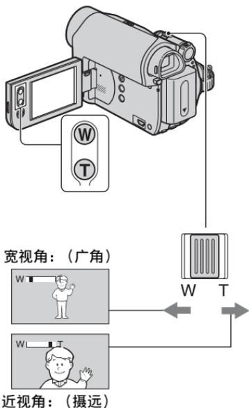
轻轻移动电动变焦控制杆进行慢速变焦。较大幅度移动变焦控制杆进行快速变焦。
