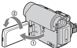
将液晶显示面板与摄像机呈 90 度打开 (①)，然后将其朝镜头一侧旋转 180 度 (②)。
