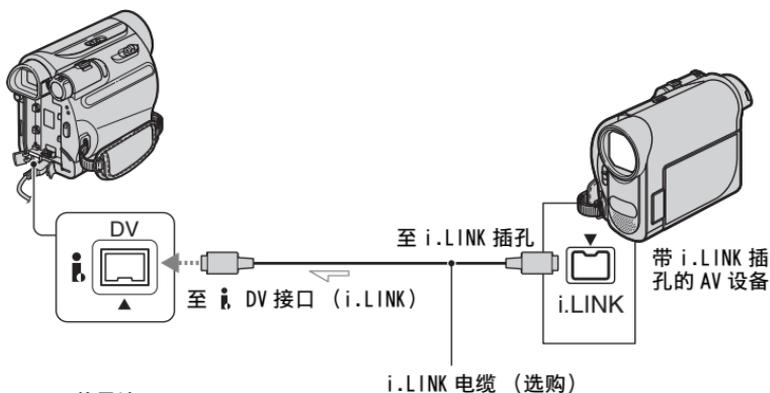
用 i.LINK 电缆将摄像机连接至其他设备时, 视频和音频信号以数字方式传输, 生成高质量图像和声音。请注意, 您无法单独输出图像和声音。
