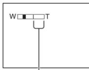
显示条的右侧表示数码变焦系数。当您选择变焦等级时出现变焦区。
