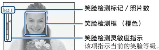
当笑脸等级达到所设定的笑脸检测灵敏度（以 ◀ 指示）时，相机自动操作快门并最多拍摄 6 张影像。拍摄影像后，笑脸快门指示灯点亮。
