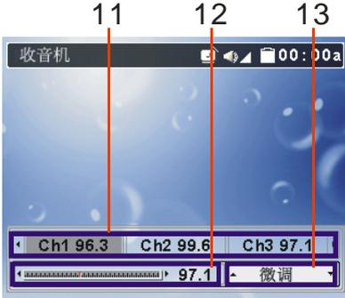
11. 存储的电台：最多可存储 8 个 FM 电台。
