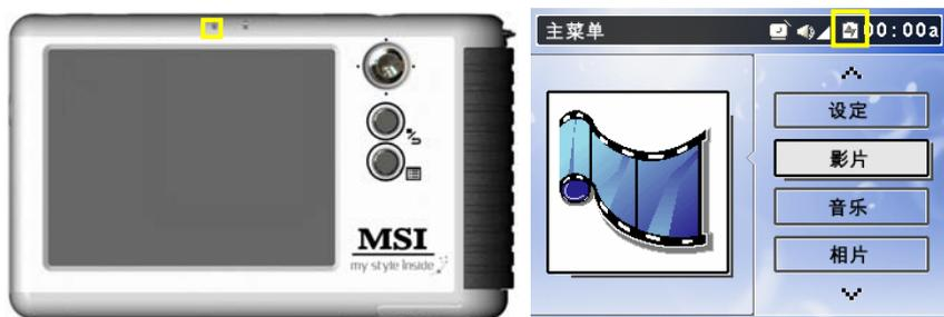
3. 蓄满电，电源 LED 指示灯会停止闪烁。要停止充电，请从 **MEGA VIEW 588 多媒体视频显示器** 上取下 AC 电源适配器。
