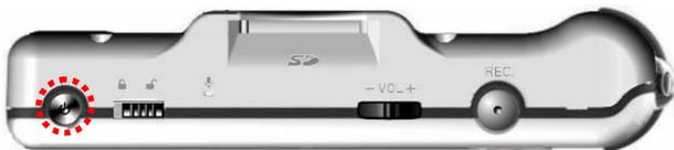
2. 把附带的 USB 线缆的迷你端接入 MEGA VIEW 588，另一端连到计算机上。
