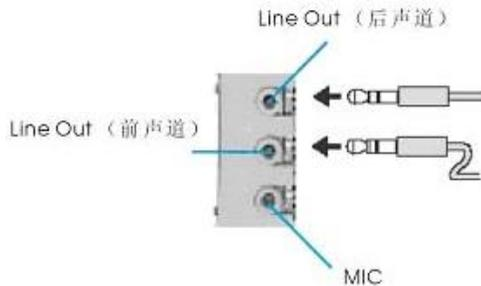
描述：在 4 声道设置下 Line In 被转换成 Line Out 功能。
