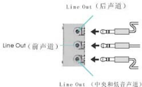
描述: 在 6 声道设置下 Line In 和 MIC 都被转换成 Line Out 功能。
