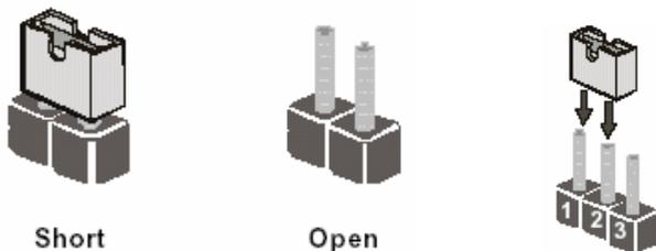
以上是 3 个管脚跳线的举例，第一个管脚和第二个管脚是短路状态。
