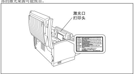
以上图例显示了打印机顶盖打开后其内部示图。
