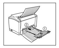
**3** 在手动进纸盘的入口处重新安装进纸盘 1 的盖子与底盘。
