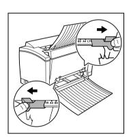
2 将纸张调整器移动到要装入的纸张 尺寸的标志处。示意图说明了针对 信纸尺寸纸张的调整器位置。
