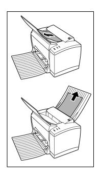
2 开启顶盖后再重新关上,以重置打印机。
