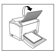
O 如果您安装的是可选面朝上的出纸 盘并希望纸张都是朝上输出,打开 面朝上的出纸盘,不要动面朝下的 托盘,将朝上/朝下选择转换按键 如右所示设置。
