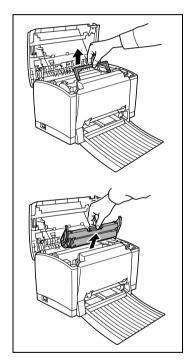
5 小心地将卡住的纸张拉出打印机。
