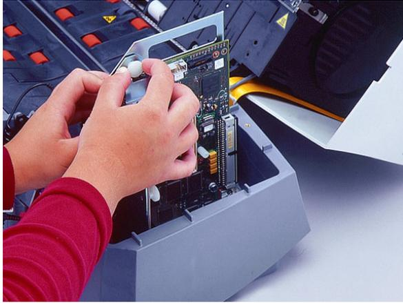
7. 确保内置打号器板安装已就位并紧固。
