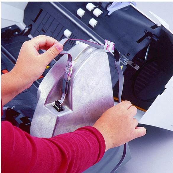
13. 剥去与内置打号器电缆相连的第一个自粘扣带垫中的敷层。
