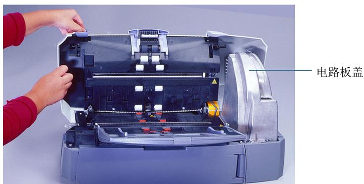
8. 使用梅花头螺丝刀卸下固定电路板盖的两颗螺钉（一颗位于前端，另一颗位于后端）。
