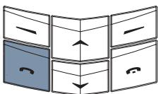
> 从待机状态屏幕，按发送键进入最近已拨打号码的清单。
