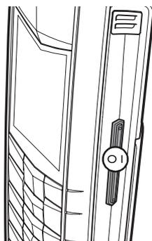
使用 Vertu 手机右侧的音量键 (O1) 可获得舒适的音量。此键为跷板式操作。
