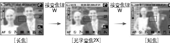
数码变焦(短焦): 当相机在数码变焦状态时，按变焦钮W可减少数码变焦倍率，放开变焦钮W数码变焦停止。按住变焦钮W缩小数码变焦，当数码变焦达到最小时，则缩小光学变焦。
