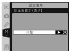
**4** 向右按下多重选择器。在相机显示屏中将出现如右图所示的信息，并且在控制面板和取景器中将显示一行破折号。若要不升起反光板而返回正常操作，请关闭相机。若显示屏允许自动关闭，反光板锁定也会自动取消。
