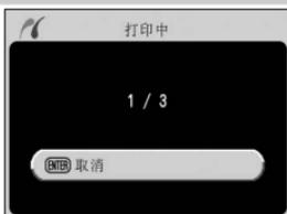
开始打印。若要在完成所有图像的打印之前取消打印并返回 PictBridge 菜单，请再次按下
