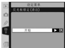
高亮显示此选项，并向右按下多重选择器以显示上示菜单。如果向右再按一次多重选择器，机顶控制面板上将出现一行虚线（“----”）。按快门释放按钮可升起反光板。反光板被锁定在升起的位置，机顶控制面板上的一行虚线开始闪烁。当关闭相机时反光板降落。
