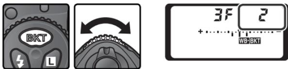
**4** 构筑一幅照片、对焦、拍摄。每次拍摄可建立在包围程序中指定的复制数量，并且每个复制都会有一个不同的白平衡。使用白平衡微调功能 (
