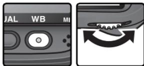
若要立刻使用新的白平衡预设值,可通过按下 **WB** 按钮并转动副指令拨盘直至机背控制面板 (📖 61) 上显示 d-0 的方法来选择预设 d-0。而在测量新的白平衡值时,没有必要选择 d-0。
