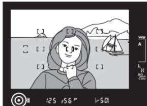
**5** 按下相机上的 **FUNC** 按钮。闪光灯将发出一次监视预闪来决定最合适的闪光级别。在此级别上闪光输出将被锁定，FV 锁定图标（
