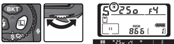
若想解除对快门速度的锁定，请按下 **L** 按钮并旋转主指令拨盘直到锁定图标从显示中消失。
