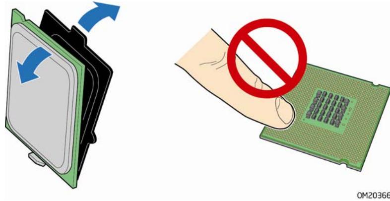
图 9. 从处理器保护罩中取出处理器
