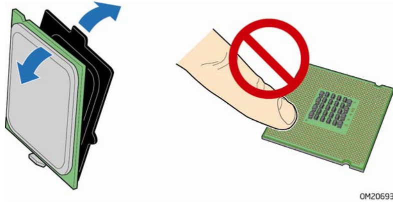
图 9. 从处理器保护罩中取出处理器
