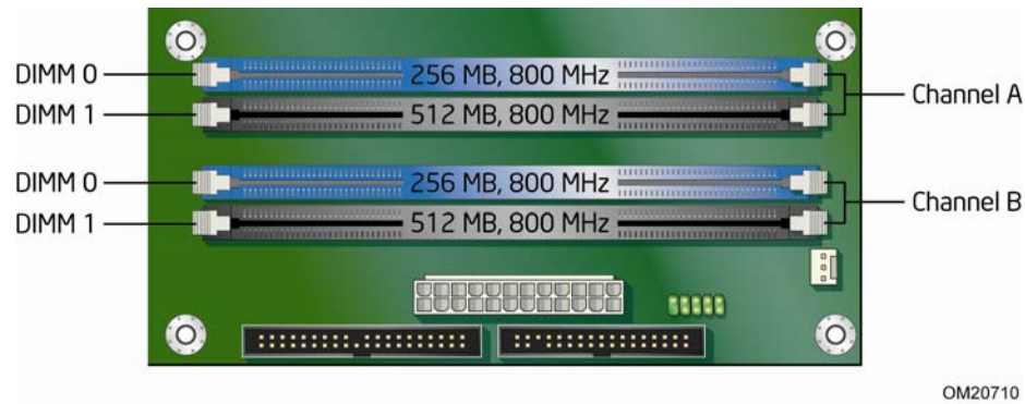
图 14. 四条 DIMM 情况下的双通道内存配置
