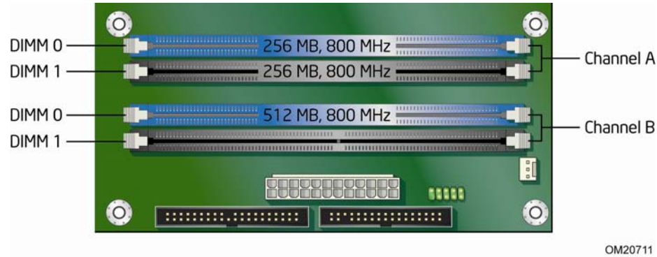
图 15. 三条 DIMM 情况下的双通道内存配置
