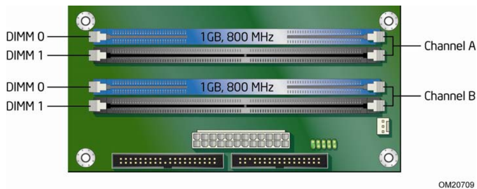
图 13. 两条 DIMM 情况下的双通道内存配置
