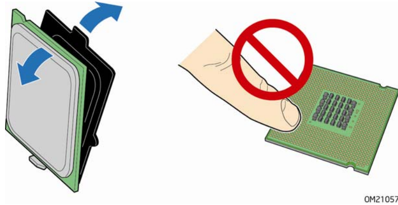
图 9. 从处理器保护罩中取出处理器
