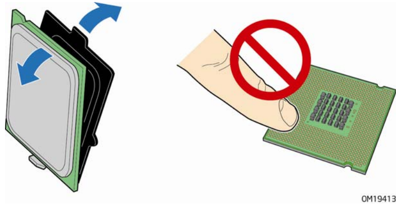
图 9. 从处理器保护罩中取出处理器
