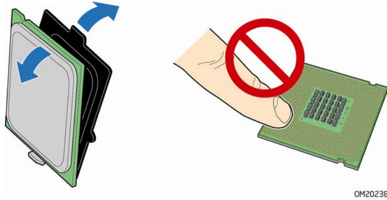
图 10. 从处理器保护罩中取出处理器
