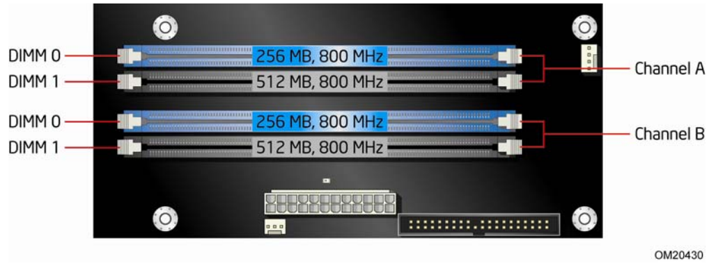
图 18. 采用四条 DIMM 的双通道内存配置
