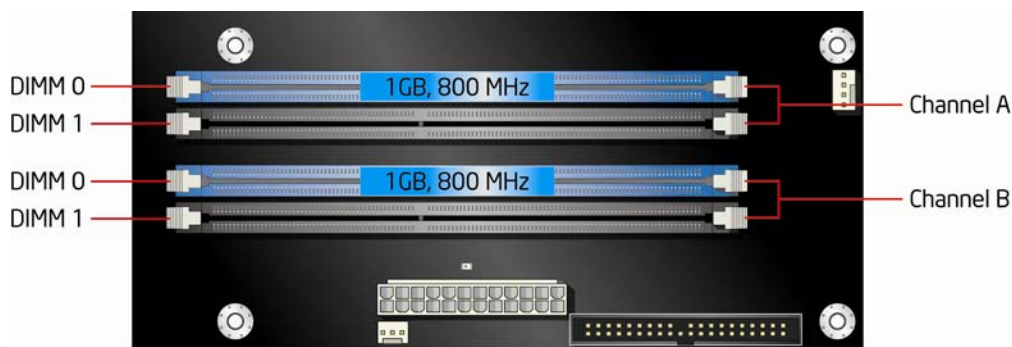
图 17. 采用两条 DIMM 的双通道内存配置
