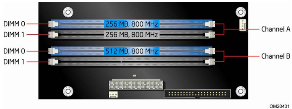
图 19. 采用三条 DIMM 的双通道内存配置
