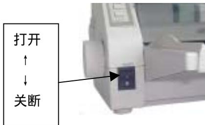
图 2-7 电源开关操作方式
