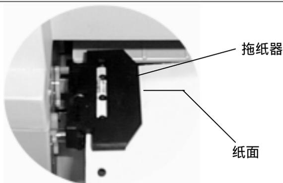
图 3-8 安装连续纸于拖纸器齿轮上
