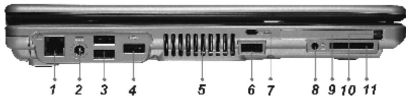
1. 调制解调器端口 连接到电话线上，用于拨号上网。
