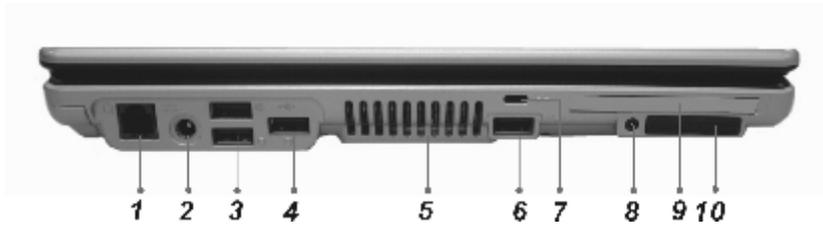
1. **调制解调器端口** 连接到电话线上，用于拨号上网。
