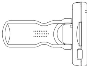
3. 將主機底部對準車架靠緊，並將主機依圖示向內推至定位。
