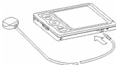
將主機上方的外接延長天線保護蓋打開，將外接天線的接頭插入天線插孔，便可使用外接天線，增強收訊。
