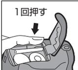
1回押す 電池/SDメモリーカードカバーを開き、メモリーカードを1回押して取り出します。
