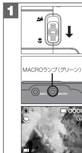
モードダイヤルを にして、撮影距離切替スイッチを (マクロモード) に切り替えます。MACROランプの点灯と液晶モニターに が表示され、マクロモードに設定されたことをお知らせします。
