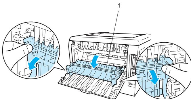
9 用双手轻轻将卡住的纸张拉出热熔单元。
