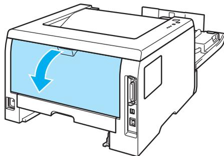
8 朝您的方向拉住左右手两侧的把手，打开热熔单元 (1)。
