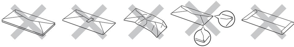
如果您使用了任何以上列举的信封，将可能导致损坏打印机。这样的损坏不能获得 Brother 公司的保修服务。
