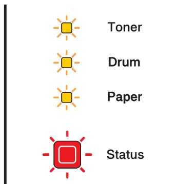
如果您看到如上图显示的维修呼叫指示，请关闭打印机电源，等待几秒钟，再次打开电源并且尝试再次打印。如果您在再次打开打印机后仍不能清除错误并看到同样的维修呼叫指示，请致电 Brother 公司指定的维修站。当你同时按“Go”和“Job Cancel”按钮时，指示灯将会如下表所示亮起以说明错误。
