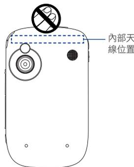
為確保最佳的電話效能，並確保人們在 RF 能量之下的暴露量未超過相關標準所設定的方針，務必在手機的正常使用位置使用它。在撥出或接收電話時，切勿沒必要地接觸或握住天線區域。與天線區域接觸可能會降低通話品質，並導致您的手機在運作時比較耗電。在電話通話時避免接觸天線區域，可提供最佳的天線效能和電池壽命。
