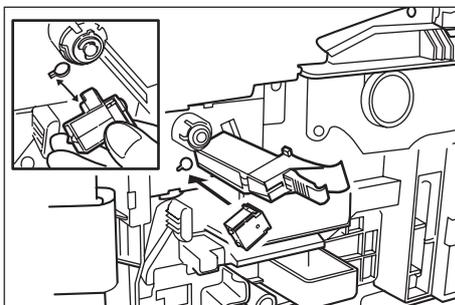
**13** 将静电部分拉出到底，然后在 ① 辊接触到栅网清洁器的垫片之间，将其重新推入复印机。重复此操作数次。
