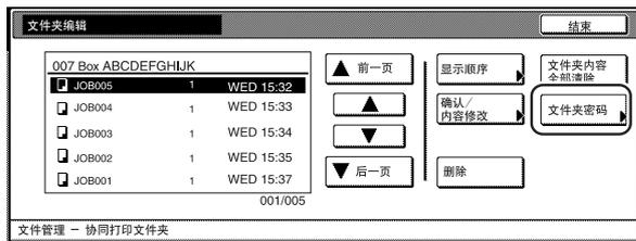
**5** 使用数字键盘输入新的密码，然后触摸“确认”键。新密码完成登录，同时触摸面板返回步骤 4 中的画面。
