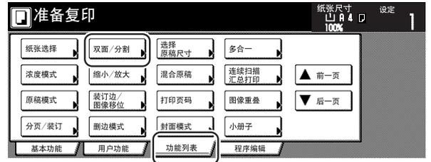
3 如果您要对双面原稿进行复印，触摸“双面至双面”键。如果您要对摊开原稿进行复印，触摸“书本至双面”键。如果您要对单面原稿进行复印，触摸“单面至双面”键。
