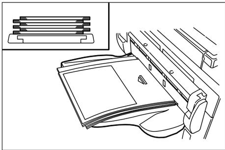
\* 放置如 8 1/2"×11"、A4R 以上的大尺寸纸张时，应将支撑伸缩架拉出。
