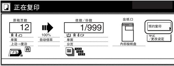
您可在其它复印作业完成之前输入相应的复印设定，并扫描准备复印的原稿。
