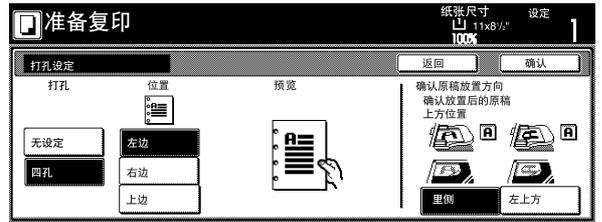
\* 打孔将按图示完成（复印件正面视图）。
