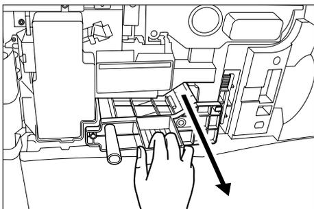
**13** 将机内接纸盘放回原位。关闭前盖板。
