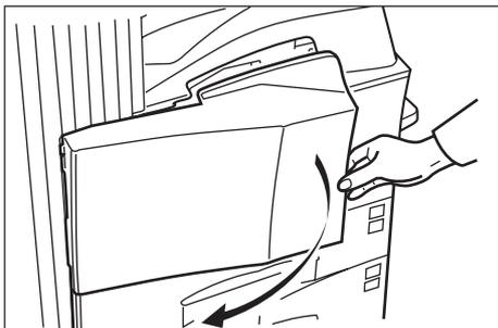
**10** 打开机内接纸盘盖板，取出卡住的纸张。
