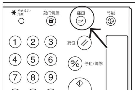
1 按 [插入] 键使 [插入] 键中的指示灯亮起。“可以插入”显示。
