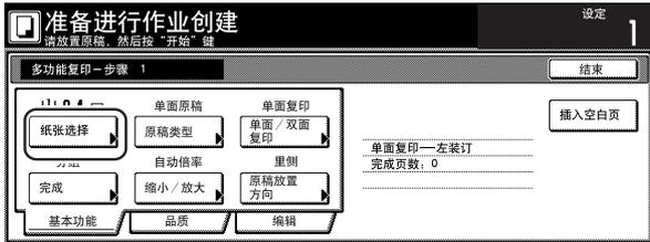
**2** 触摸包含与所需尺寸复印纸的供纸盒相对应的按键，然后触摸“确认”键。触摸面板将返回步骤 1 中的画面。
