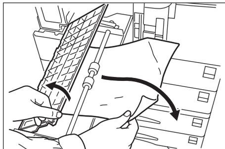
**7** 顺时针转动旋钮，以松开卡在机内接纸盘部分的纸张。
