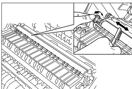
**5** 完成清洁操作后，请将清洁刷放回复印机并关闭左侧盖板 1 和前盖板。
