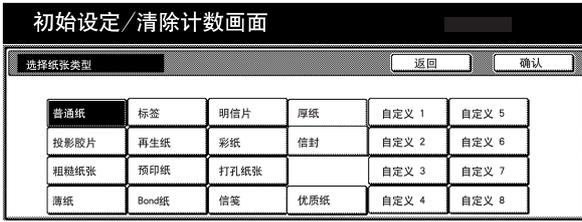
7 再次触摸“确认”键。触摸面板将返回步骤 2 中的画面。触摸“结束”键。触摸面板将返回“基本功能”制表键的内容。
