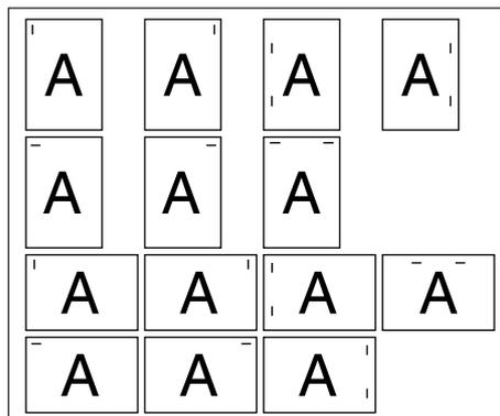
4 放置要复印的原稿。检查原稿上方的方向。
