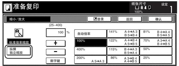
4 相应触摸“+”键或“-”键，指定图像宽度，再是长度的所需缩放倍率。所需的倍率也可通过触摸相应的“数字键”键，然后使用数字键盘直接输入。
