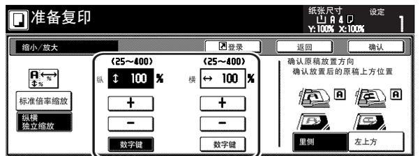
5 触摸面板上的相应键，指定原稿放置的方向。
