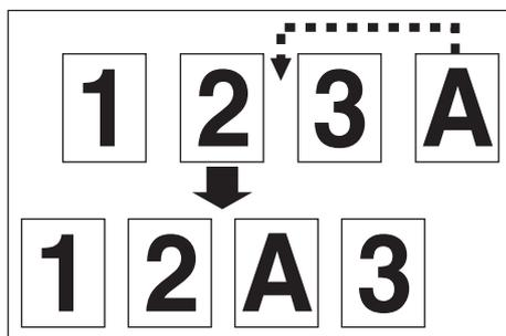
4 当复印完成时，再按一次 [插入] 键。[插入] 键上的指示灯关闭。取出复印完的原稿，放回之前取出的原稿。然后按 [开始] 键。中断的复印作业继续进行。
