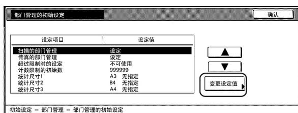
**2** 当部门代码超出其设定限量时，要立即停止继续使用机器（即从停止当前作业起），请触摸“立即停止使用”键；要在处理完当前作业后再停止使用，请触摸“下一步起停止使用”键；要产生错误信息，请触摸“仅警告”键。
