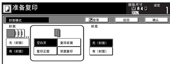
6 根据需要，触摸“有(封面)”键或“无(封面)”键，选择您是否要包含封底。如果选择了“有(封面)”，进行封底设定的屏幕将显示。
