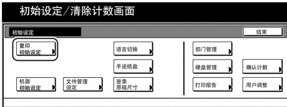
**3** 用数字键盘输入 4 位数管理代码。30 cpm 复印机的出厂初始设定是“3000”，40 cpm 复印机的是“4000”，以及 50 cpm 复印机的是“5000”。
