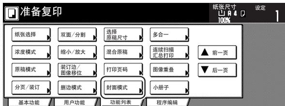
4 触摸“有(封面)”键。进行封面设定的画面显示。
