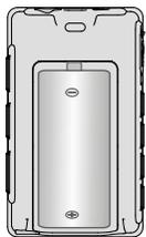
2 将镍氢电池装入电池仓，并确保电池正负极方向正确，然后盖上电池仓盖。
