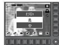
3. 屏幕显示如图所示，并且打印影像，如果沒有选择的影像，将显示[没有影像!]信息，正在打印时，按BACK钮，可取消打印。
