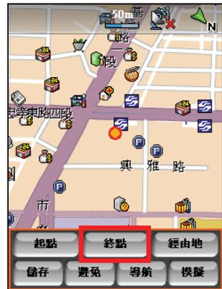
3. 當您設好起點、（經由地）與終點之後，點選浮動工具列上的 [模擬]，讓系統幫您規劃導航路徑，螢幕會出現導航起點的地圖畫面，模擬導航即開始。
