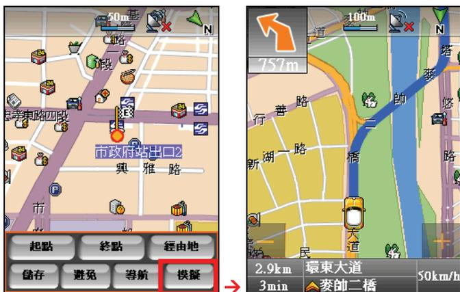
4. 欲結束模擬導航，用手寫筆輕按模擬導航地圖的任一位置，直到出現浮動工具列，接著點選 [結束]，便可結束模擬導航。
