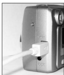
USB端口位于相机左侧的数码接口槽之中。
