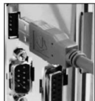
• **步骤1** 将USB电缆较小的一端连接到数码相机的USB端口上。
