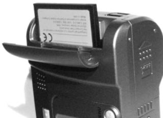
在插入时，把住内存卡使其插头连接器朝向相机。内存卡的正面也应朝向相机的正面。然后，将内存卡推入内存槽中，关闭内存槽盖。
