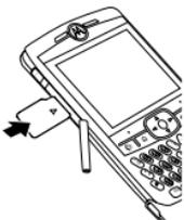
请按照图示正确安装内存卡。
