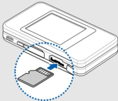
3. 将存储卡推入存储卡槽直到锁定位置。
