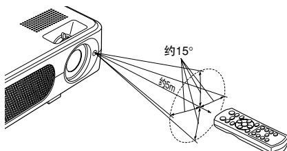
投影机后部操作遥控器时，根据投影表面形状和材料的不同，光线通过投影表面反射并可能在传播较短距离后到达投影机。
