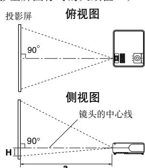
**a**是指从镜头到投影屏的距离(m)，本机的适用范围为1.19m~9.13m。**H**是指从图像底边到镜头中心线的高度。
