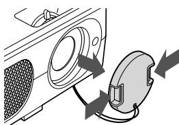
要接通电源时，请务必先卸下镜头盖。否则，镜头盖套在上面有可能因受热而变形。
