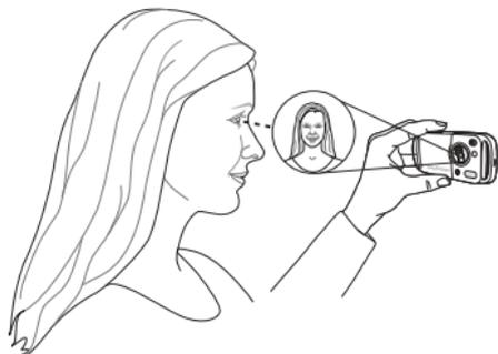
按照插图所示的方法握住手机，以便您能在镜头旁边的反射镜中看到自己的映象。按相机按钮来拍摄照片。
