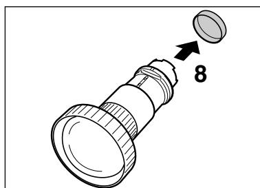
**9** S'assurer que les deux rainures sur la bague de fixation d'objectif orientée avec la face vers le haut.
