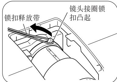
**6** 先将镜头盖的凸起 ① 插入投影机的凸起孔 ② 中，然后将凸起 ③ 推入凸起孔 ④ 中，直到喀嗒一声到位为止。
