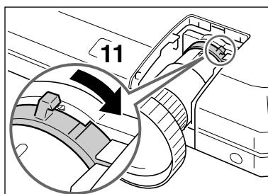
**12** Après l'insertion de la moitié supérieure des languettes du cache-objectif dans les trous de languette du projecteur, glisser le cache-objectif vers le projecteur jusqu'à ce qu'il s'emboîte en place.
