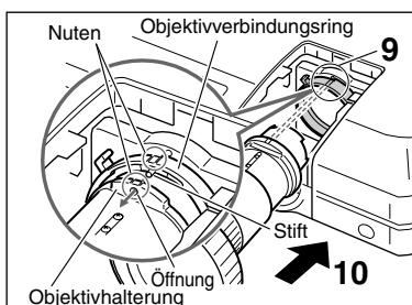
**12** Schieben Sie, nachdem die obere Hälfte der Objektivabdeckung in die Projektorsperrzungenöffnungen eingesetzt worden ist, die Objektivabdeckung zum Projektor hin, bis diese einrastet.
