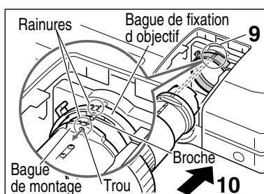
**11** Tourner la languette d'arrêt de la bague de fixation d'objectif dans la direction des flèches comme indiqué sur l' illustration jusqu'à ce qu'elle s'arrête.
