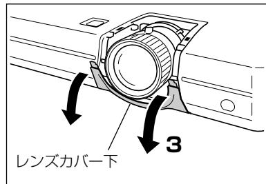
4 レンズが落ちないように手で押さえながら、レンズ固定レバーを図の矢印の方向に回します。
