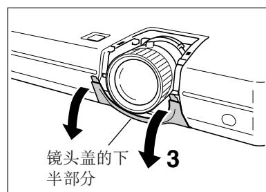
**4** 要拆下镜头，用一只手沿图中的箭头方向转动镜头接圈锁扣凸起的同时，请用另一只手抓住镜头，以防止镜头跌落。
