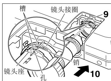
**11** 沿图中箭头所示的方向转动镜头接圈锁扣凸起，直到停止为止。
