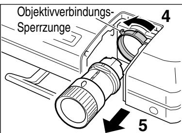
**Verfahren zum Lösen eines schwer drehbaren Objektivverbindungsringes**
