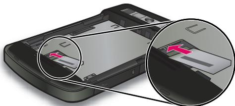
3. 將 SIM 卡滑入 SIM 卡插槽。
