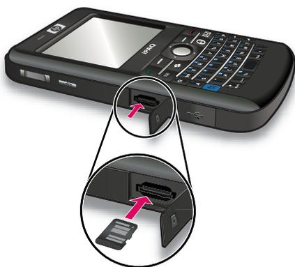
3. 將卡片推至插槽定位，鎖定卡片。
