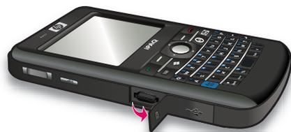
4. 推一下插槽中的卡片，解除鎖定卡片。
