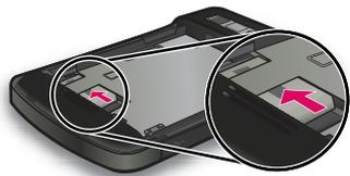
**附註：** 若已安裝電池，必須先將電池取出，才能插入 SIM 卡。SIM 卡是由行動電話服務供應商提供。此外，確定金屬接觸點朝下，而且凹角的位置正確。若未正確將 SIM 卡插入 HP iPAQ，畫
