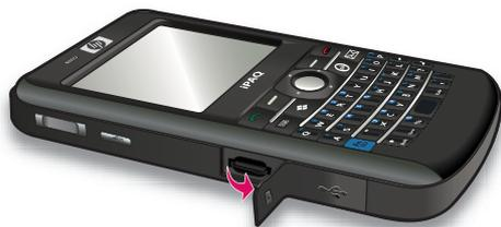
2. 將儲存卡金屬部分向前，面對 HP iPAQ 尾端輕輕滑入 MicroSD 的插槽。
