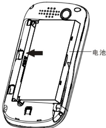
**注意：**请按照图示正确操作以防损坏电池接触点。
