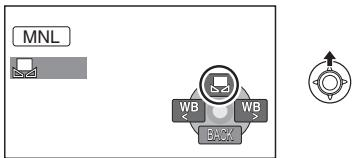
[WB] 显示停止闪烁时，表示设置已完成。
