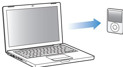
要设置如何将音乐从电脑添加到 iPod nano，您可以先将 iPod nano 连接至电脑，然后使用 iTunes 的偏好设置来选取 iPod nano 设置。
