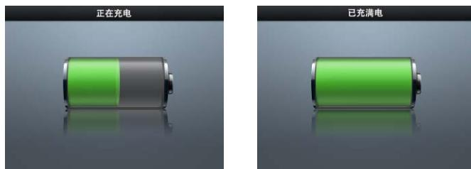
如果您没有看到充电屏幕，则 iPod nano 可能未连接至高功率 USB 端口。请尝试电脑上的另一个 USB 端口。
