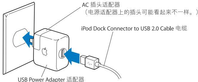
**【警告】**请确定在将电源适配器插入电源插座之前，适配器已完全组装好。
