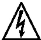
■ 为了防止触电，地线必须与插座的地线或者接地工程的一端连接。绝对不允许与煤气管，自来水管，电话地线，避雷针连接。以防事故。
